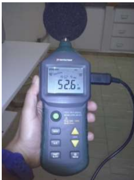
Figura 1 - Decibelímetro digital modelo ITDEC4010 utilizado nas medidas de níveis de ruídos nos ambientes da UniRV.
